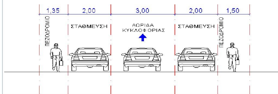
Τυπική διατομή οδού Εργ. Πρωτομαγιάς τυπική διατομή ΔΤ_12
